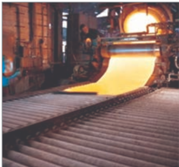
شکل ۲۰- فرایند ساخت شیشه تخت
