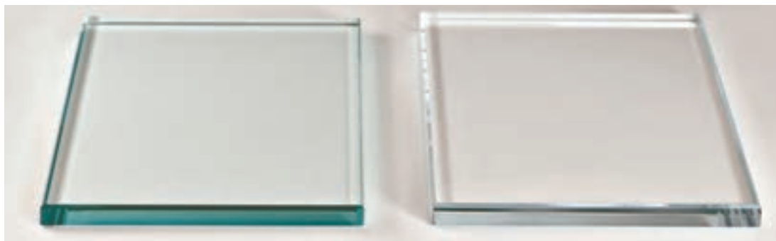
الف ب شکل ۱۶- الف) شیشه بی‌رنگ شده ب) شیشه بی‌رنگ نشده
