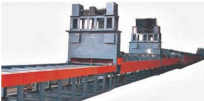
شکل ۱۲- کوره رولری برای عملیات تمپر حرارتی
