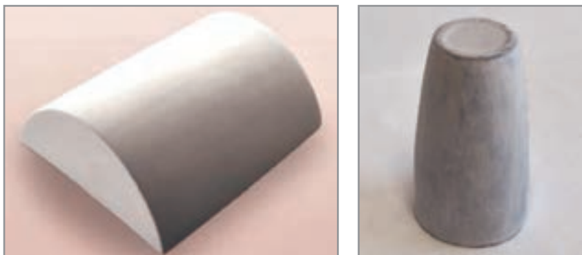
شکل ۲۷- قالب فلزی مورد استفاده در دراپینگ
