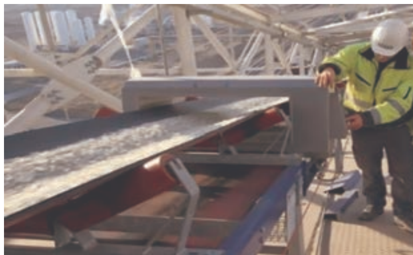
شکل ۳۱- فرایند آهن‌گیری هنگام انتقال مواد پودر شده
