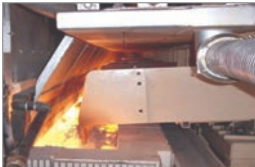
شکل ۱۷- دریچه بارریز کوره‌های شیشه تخت
