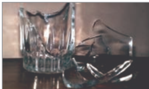
شکل ۸- شکستن شیشه سرد با ریختن مایع داغ
