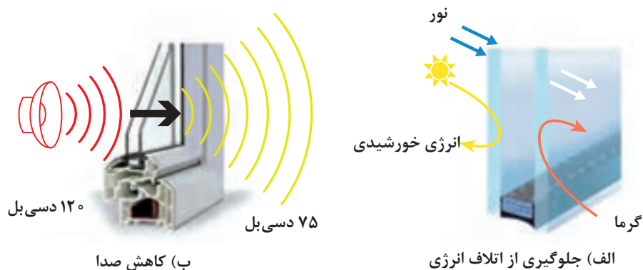
شکل ۴۲- عایق حرارتی و صوتی شیشه دو جداره
