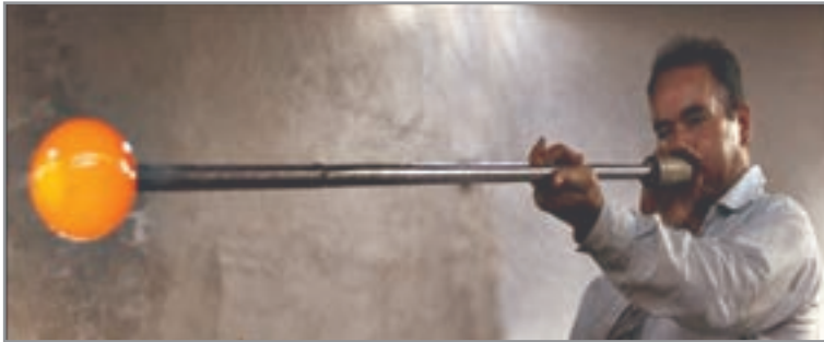
شکل ۵- ایجاد حباب در لقمه مذاب با دمیدن
