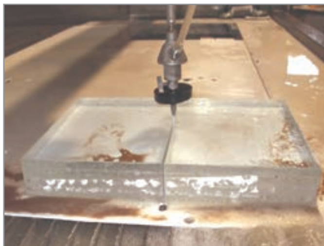
شکل ۳۱- برش شیشه با واترجت
